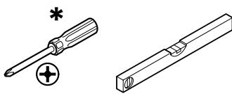
**\* VORSICHT:** Bei Verwendung eines Akkuschraubers (nicht empfohlen) möglichst niedrige Drehmomentstufe wählen!
